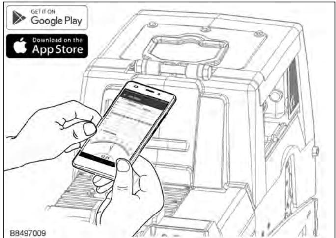
Con la aplicación de servicio de Ammann puede acceder a los datos de ServiceLink de todas las máquinas en el entorno de su red inalámbrica o Bluetooth LE. Además, puede introducir en la aplicación la información de servicio y mantenimiento y las operaciones que deba realizar en cada máquina, así como completarla y almacenarla directamente en el software de ServiceLink de la máquina.
